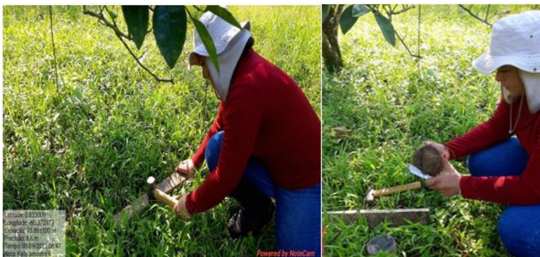
Figura 3. Introdução do anel metálico com ajuda da marreta, realizado dia 05 de setembro de 2022, na vicinal 10, km 17 no município de Rorainópolis-RR, (fonte: do Autor).
